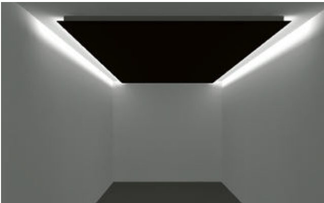
Deckenvoute mit Lichtrichtung nach außen ceiling cove with light direction to the outside
